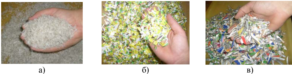
Рисунок 1- Компоненти композиційного матеріалу: а) –ХТП; б) –ОЦ; в) – подрібнені відходи Tetra Pak
