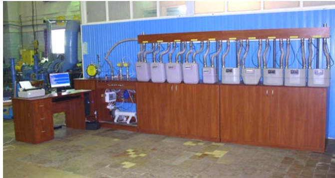
Рисунок 1 – Установа "Темпо-3" у виконанні для повірки мембранних лічильників газу
